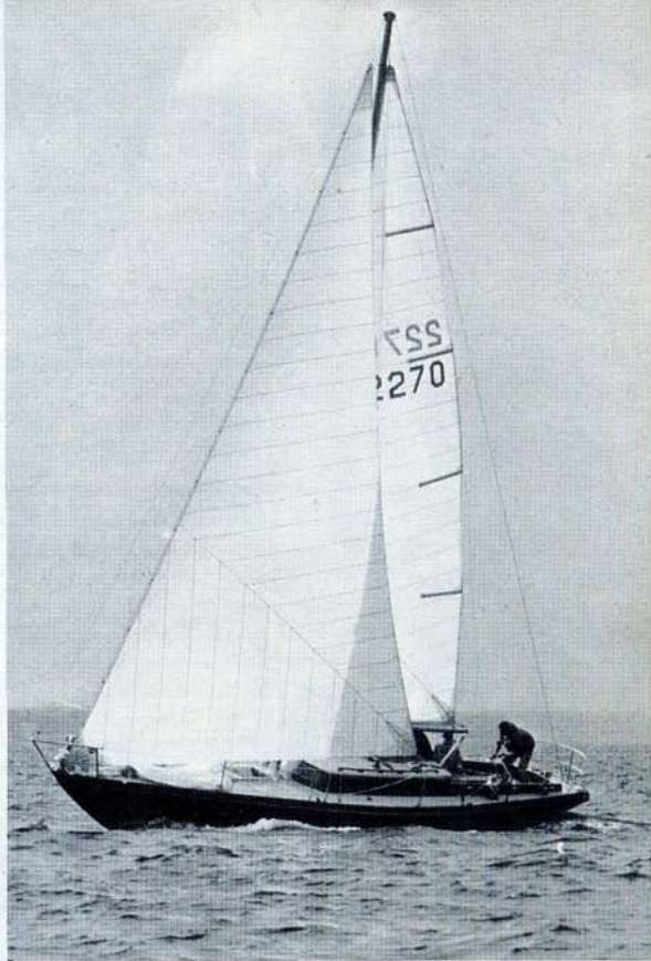
Par les changements de voiles d'avant, ou par la réduction de la grand-voile, Carter maintient constamment son bateau à l'angle de gîte optimum, lequel dépasse rarement 15°. Ici, sous génois n° 2, on notera le manque de raideur de l'étai que nous signalons par ailleurs.
